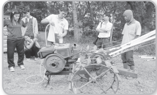
น้ำมันดีเซลที่ได้จากการเผาขยะพลาสติก นำมาใช้กับรถไถเดินตาม
